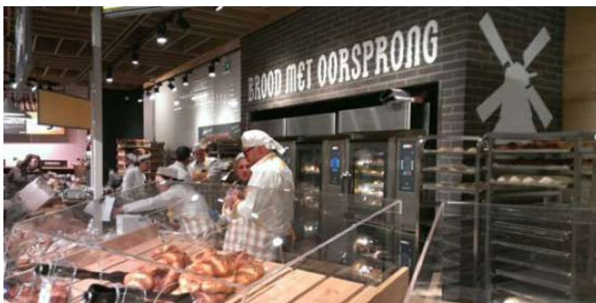
Jumbo Supermarkt in Maastricht heeft met LED-verlichting een geïnstalleerd verlichtingsvermogen van 11 W/m 2
